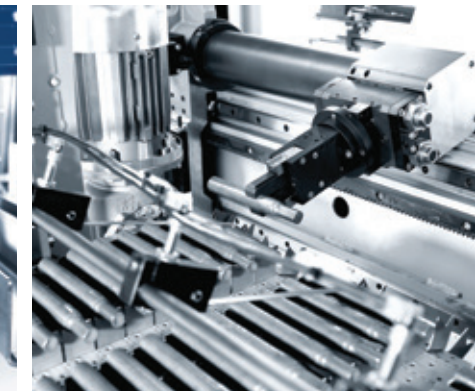
Système d'alimentation par chaîne avec fixations prismatiques pour positionner des ébauches aux formes variées.
