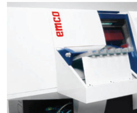
Goulotte d'alimentation à plusieurs voies pour les bruts à symétrie de révolution. Un capteur surveille la disponibilité des bruts pour chaque chargeur.
